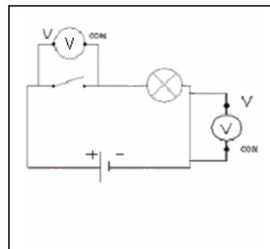
2. Réaliser sur la platine le montage correspondant au schéma et mesurer la tension aux bornes de chaque dipôle avec l'interrupteur ouvert puis fermé.
