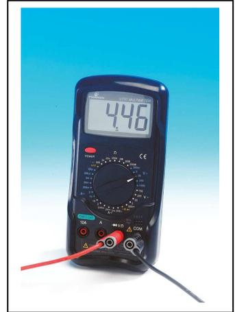
**1. Placer le commutateur du multimètre dans la zone V=.**
